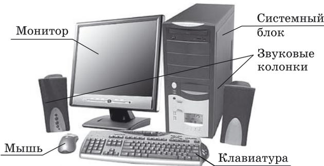
**Рис. 4.2.** Базовый комплект устройств ПК
