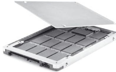
**Рис. 4.6.** Твёрдотельный диск
